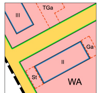
Flächen für Stellplätze, Garagen und Tiefgaragen mit und ohne Festsetzung der Einfahrten
