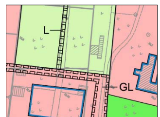
Sicherung von Leitungsrechten (L) auf Privatgrundstücken erforderlich, ggf. in zusammen mit Gehrecht (GL)
